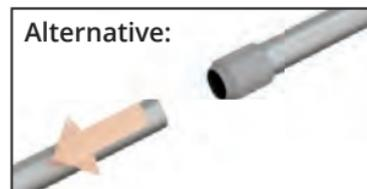
4. Schieben Sie das untere Teilsystem auf das untere Rohr der Gehstütze und klicken Sie das obere Teilsystem am oberen Rohrende fest. Anschließend platzieren Sie wieder den Gummifuß auf dem Rohr der Gehstütze **oder** stecken die Rohre zusammen. Verwenden Sie den Sechskantschlüssel, um die drei Schrauben anzuziehen und die STEETS Abstellhilfe am niedrigsten und höchsten Punkt des Gehstützenrohrs zu befestigen.
